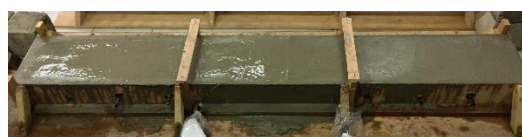
(d) Benda uji balok beton bertulang
