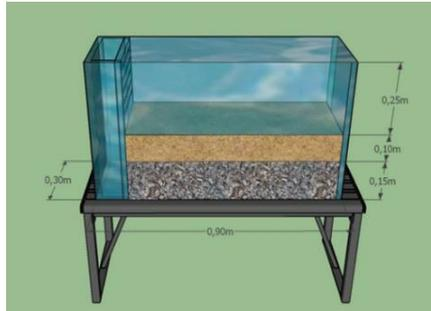
Gambar 2 Gambaran lahan basah buatan skala laboratorium
