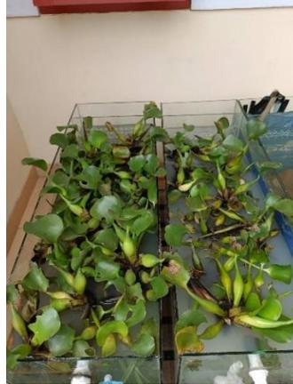
Gambar 4 Penanaman Eceng Gondok pada Bak Lahan Basah Buatan
