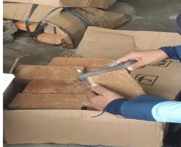
Gambar 2 Pengujian ukuran dan toleransi batu bata.
