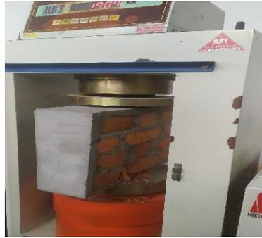
Gambar 3 Proses pengujian kuat tekan
