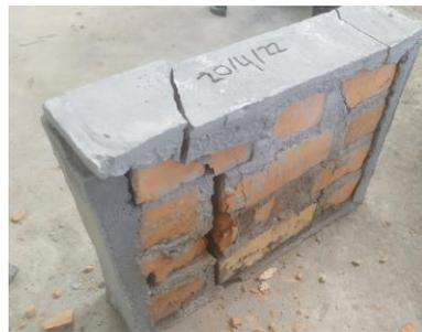
Gambar 5 Keruntuhan pada ikatan *flemish*
