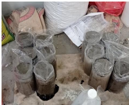
Gambar 1 Perendaman beton dengan asam sulfat
