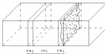
Gambar 4 Posisi bidang patah di pinggir kanan pada benda uji menurut SNI 4431
