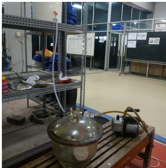
Gambar 1 Tahap vacum beton
