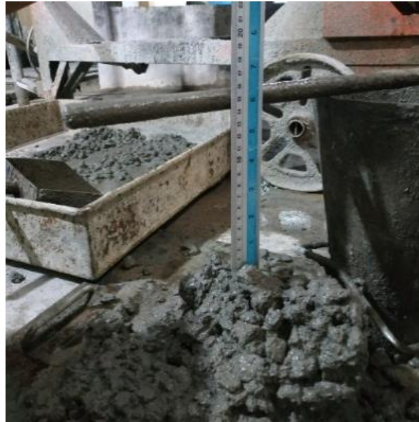
Gambar 3 Hasil pengukuran slump
