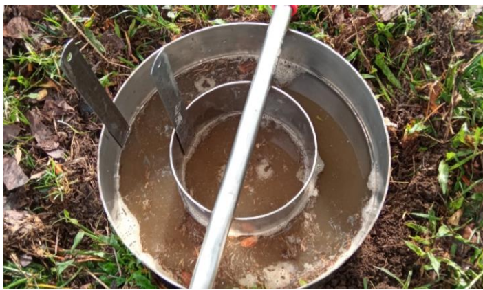
Gambar 3 Pengukuran laju infiltrasi dengan Infiltrometer
