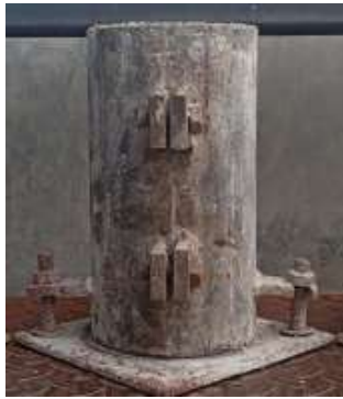
Gambar 1 Pencetakan spesimen uji tekan
