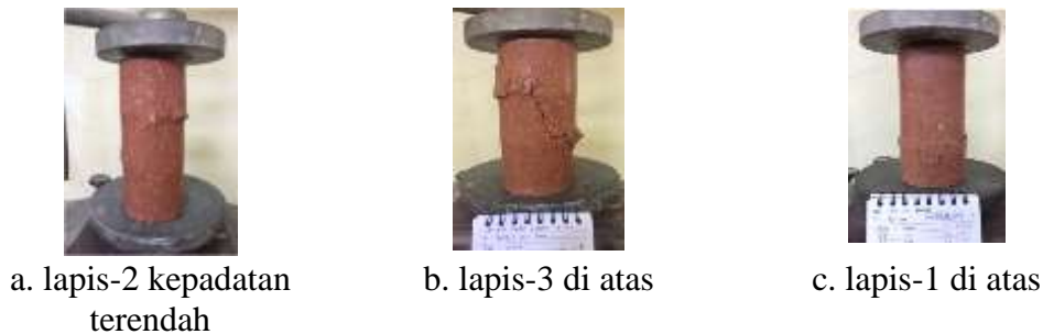
Gambar 11 Bentuk keruntuhan sampel non-seragam
