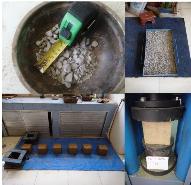
Gambar 2 Persiapan limbah konstruksi lolos saringan #12,5 mm, benda uji, dan uji tekan benda uji
