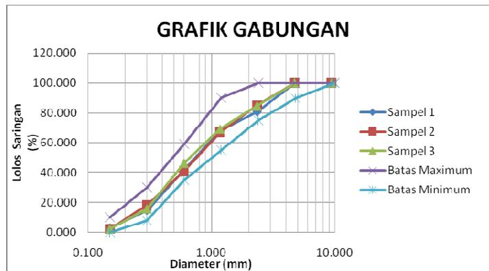
Gambar 1 Grafik gabung analisa lolos saringan agregat halus
