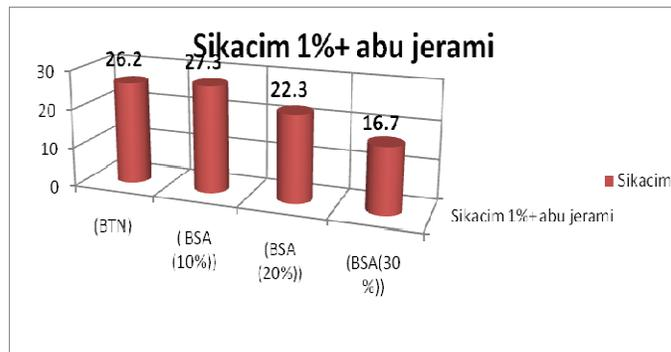
Gambar 3 Grafik hasil pengujian kuat tekan beton rata-rata.
