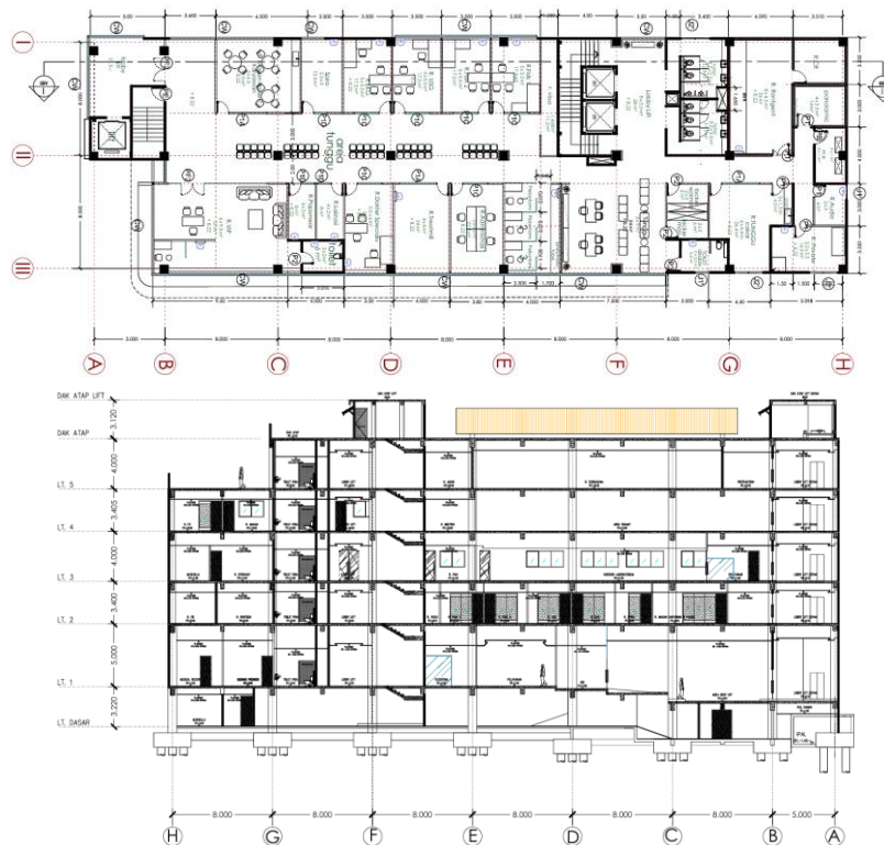
Gambar 3 Denah dan Elevasi Struktur Bangunan yang ditinjau
