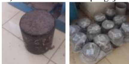
Gambar 3 Benda uji untuk pengujian pengembangan tanah, (a) benda uji selesai dipadatkan, (b) proses pemeraman
