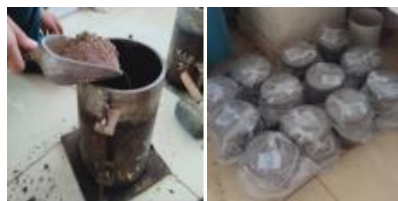
Gambar 2 Benda uji untuk pengujian CBR, (a) proses pembuatan benda uji, dan (b) benda uji yang sedang diperam
