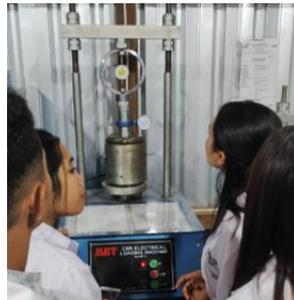
Gambar 9 Pengujian CBR laboratorium
