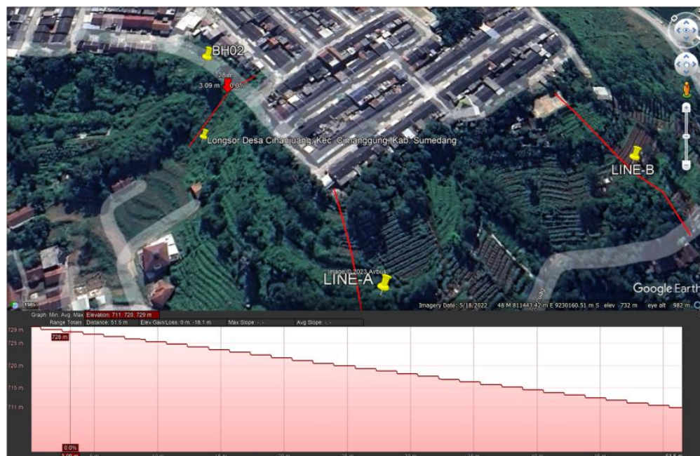
Gambar 11 Elevasi dan Panjang Kelongsoran Desa BojongKondang
