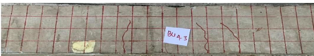
Gambar 14 Pola retak pada balok perkuatan GFRP-S tulangan korosi 4 minggu
