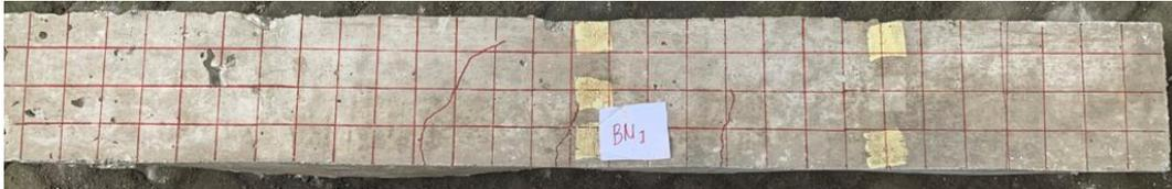
Gambar 11 Pola retak pada balok tulangan normal
