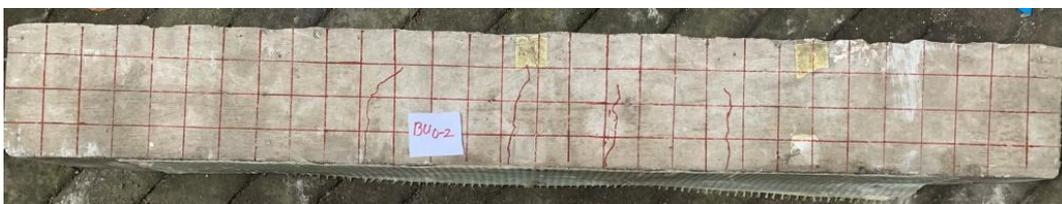
Gambar 12 Pola retak pada balok perkuatan GFRP-S tulangan normal
